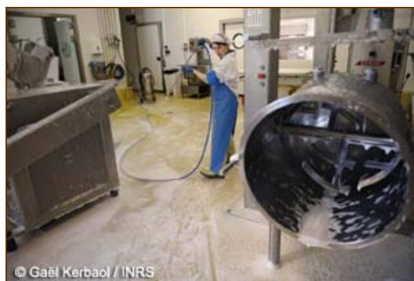
Nettoyage des surfaces dans une charcuterie industrielle à l'aide d'un canon à mousse
